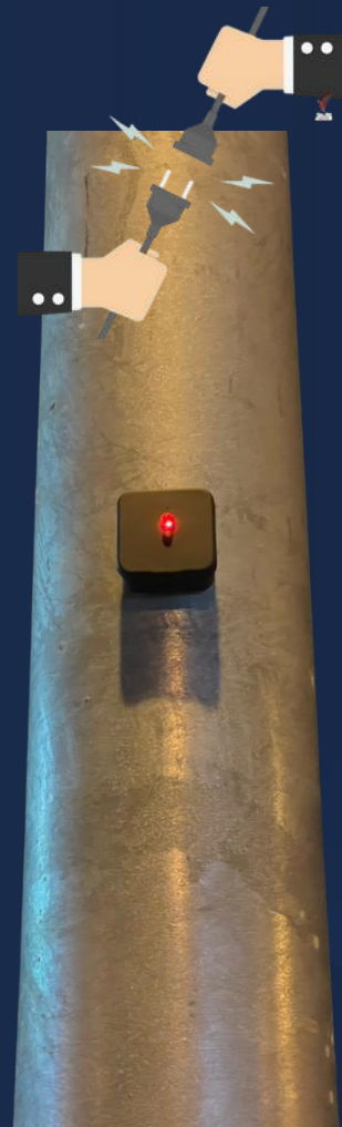
เมื่อเกิดไฟฟ้าว หลอดไฟ LED จะสว่างขึ้น
